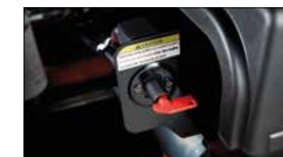
Interruptor para desconectar batería* Con sólo girar la palanca la batería puede ser desconectada de manera fácil para cualquier tipo de operación que lo requiera.
